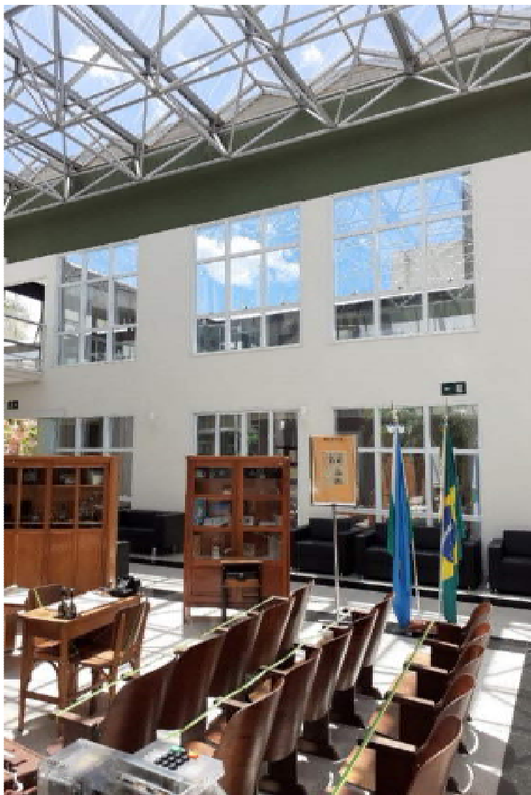
Foto 49: parede que separa o saguão interno do jardim interno, em que se vêem as esquadrias de vidro existentes (serão objeto de limpeza apenas as três janelas em posição superior).
