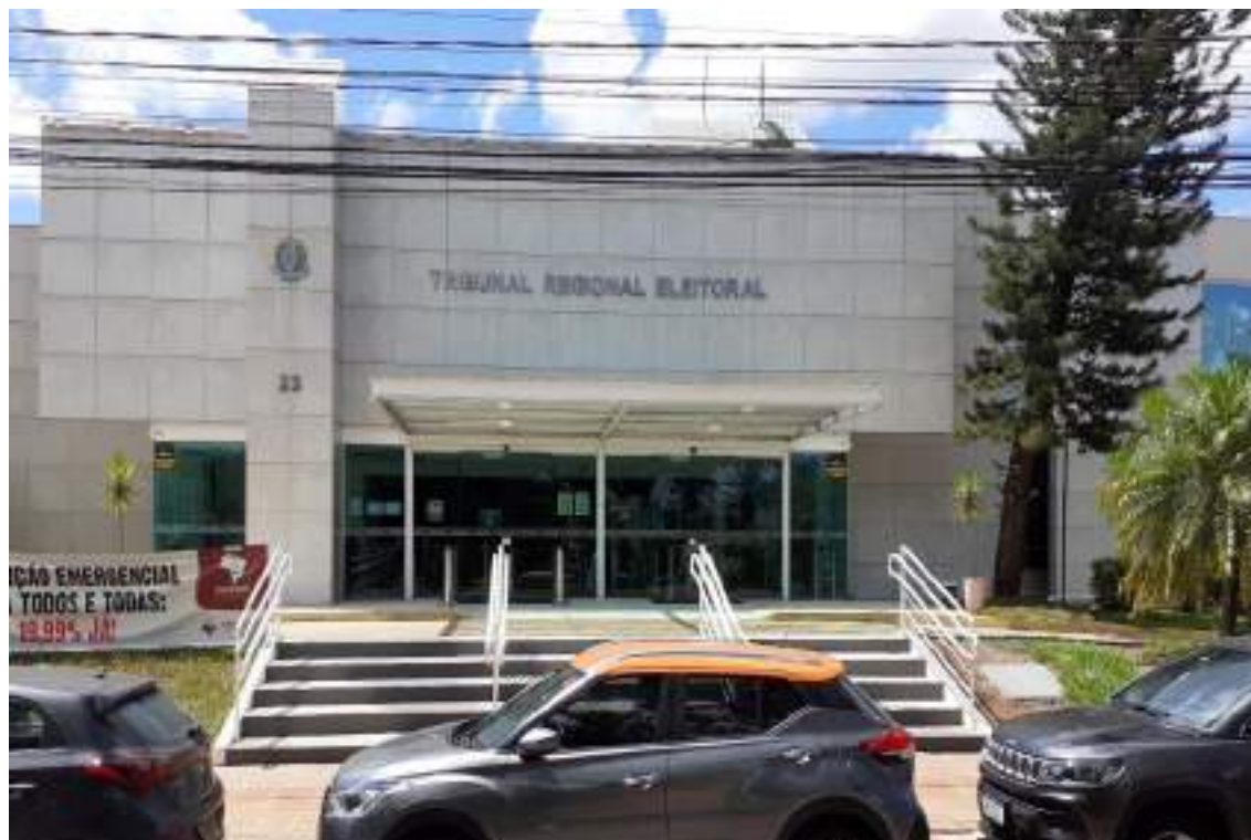
Foto 4: parte central da fachada frontal do prédio sede do TRE/MS, com destaque para as placas de granito que compõem a fachada, o acesso principal ao prédio e a marquise que cobre este acesso.
