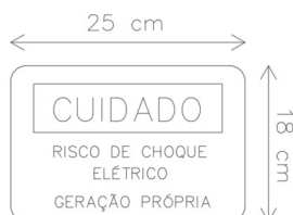
Figura 5: Placa a ser instalada no medidor
