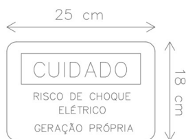
Figura 7: Placa a ser instalada no medidor
